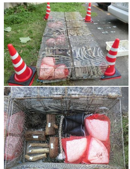
図 2 屋外暴露試験装置 (上) 海岸漂着物の配置状況 (下)
