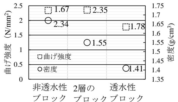
図2 ブロックの曲げ強度と密度
