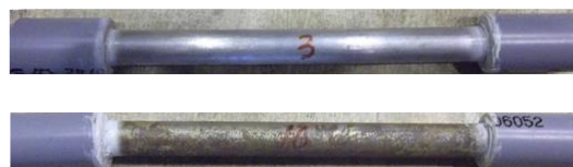
写真-1 鉄筋の腐食状況 (上：腐食無し、下：腐食有り)
