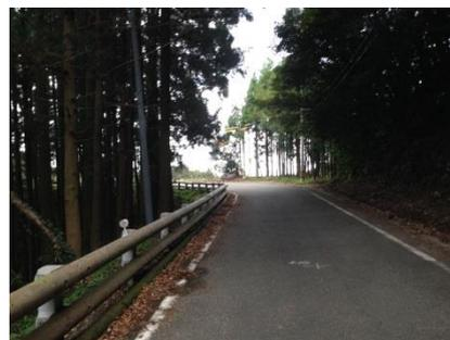
写真1 糸島市雷山雷神社周辺に設置された木製ガードレール（和光コンクリート製ウッド Gr）
