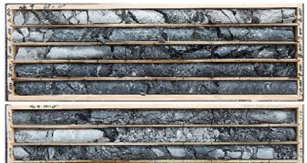
写真-1 No.9 ボーリングコア写真（破碎帯）
