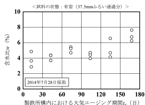
図-1 製鉄所構内における大気エージング期間の経過とともに含水比の推移（試料の状態：37.5mmふるい通過分）
