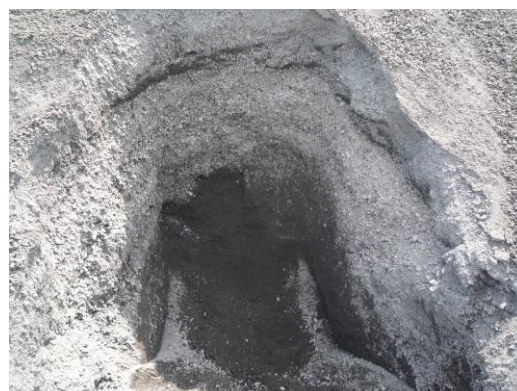
写真-1 バックホーにより掘削した製鋼スラグ山の穴
