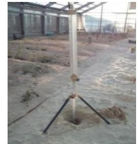
図-3 原位置透水試験器
