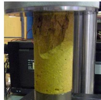
図 4 一軸圧縮試験後の供試体の様子
