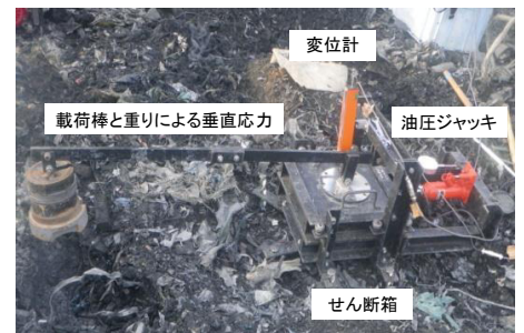
図-1 原位置一面せん断試験機
