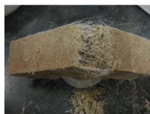
写真-2 曲げ試験後の供試体
