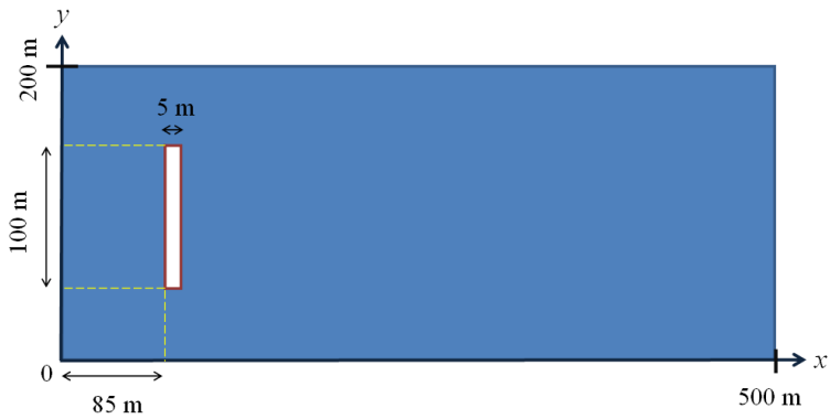
図-1 堤長の長い離岸堤が設置された離岸堤配置
