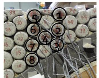
写真 2 壁石のひずみゲージ貼付位置
