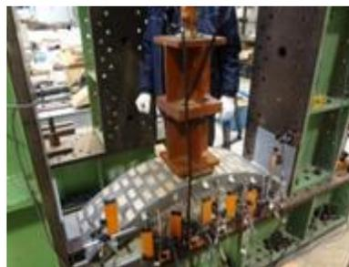
写真 3 アーチ輪石のみの模型へ集中荷重载荷実験の様子
