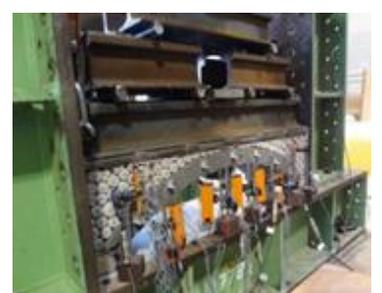
写真 4 壁石を有する模型へ 4 等分点荷重载荷実験の様子
