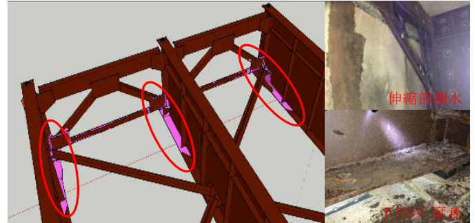
図-2 腐食状況模式図
