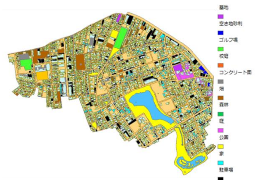
図3 美濃山橋越流に流れ込む流域の土地利用区分
