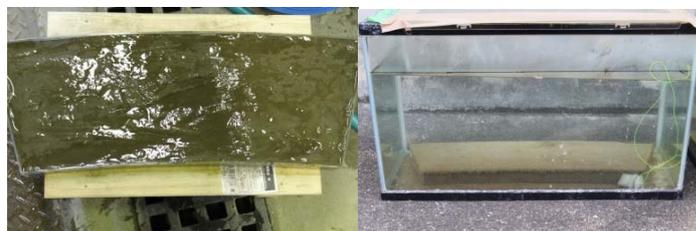
写真-1 型枠に設置した底泥
