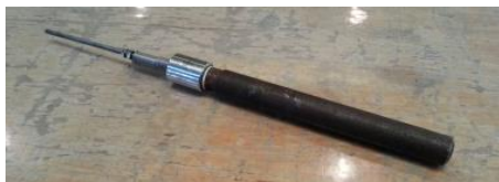
写真-3 バネの復元力を利用した衝撃入力装置
