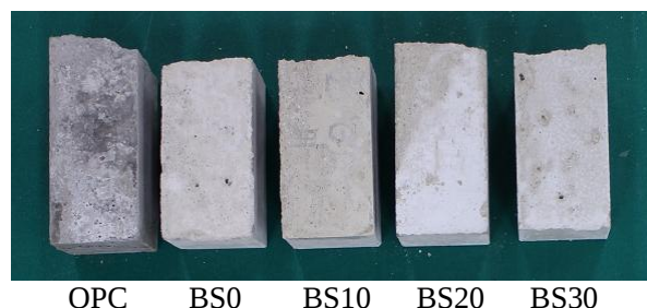
図2 加熱後の供試体の外観 (500℃)
