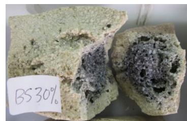
図4 加熱後の供試体の変状 (1150℃, BS30)
