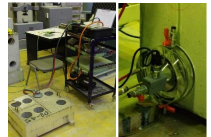
写真-1 ダブルチャンバー透気性試験(左) ダブルチャンバー透水性試験(右)
