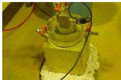
写真-2 ダブルチャンバー透水性試験
