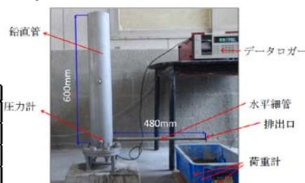
図-1 管式粘度計
