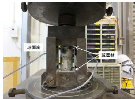
写真-1 載荷試験方法（ \phi 25\text{mm} ）
