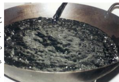
写真-1 発泡したアスファルト 2)
