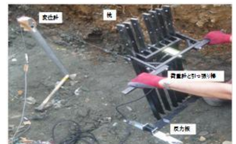
図-2 原位置土圧試験実施状況
