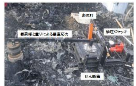
図-1 原位置一面せん断試験機
