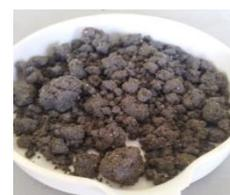
写真1 粒状固化前 写真2 粒状固化後
