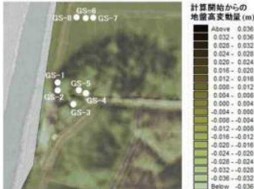
図-2 地盤高変動分布の一例（越流開始 60 分後）
