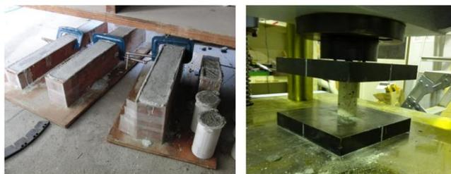
(a) 打設後 (b) 圧縮試験
