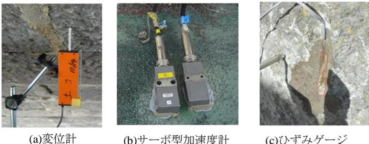
(a)変位計    (b)サーボ型加速度計    (c)ひずみゲージ
