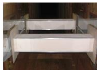
(a) 角柱単独時 ( L/D=2.44 ) (b) タンデム角柱 ( s=3.5, L/D=4.44 )
