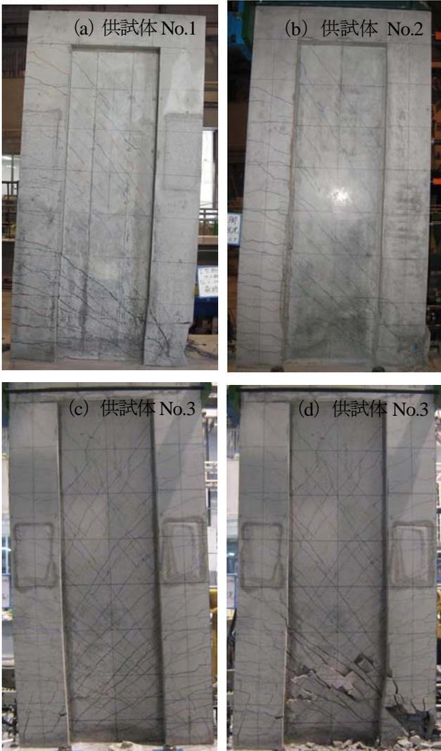
写真-1 各供試体の破壊状況
