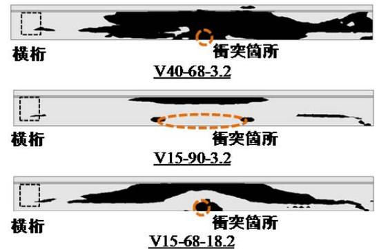
図-8 衝突条件のひび割れ性状への影響
