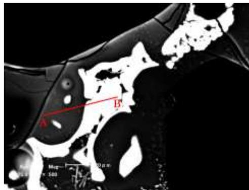
図 3 SEM-EDX 線分析 SEM 画像
