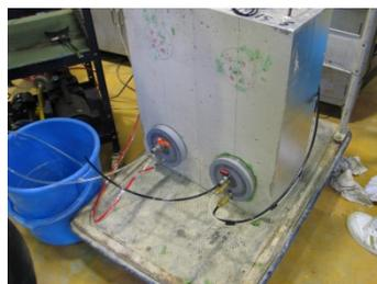
写真-2 透水性試験 (ダブルチャンバー法)
