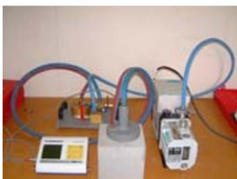
写真-1 透気性試験 (ダブルチャンバー法)
