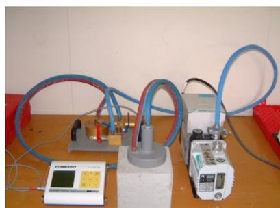
写真-2 ダブルチャンバー法
