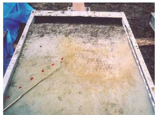
写真.3 幅広型ジオスライサーでの \gamma 線強度異常値 (赤破線部)
