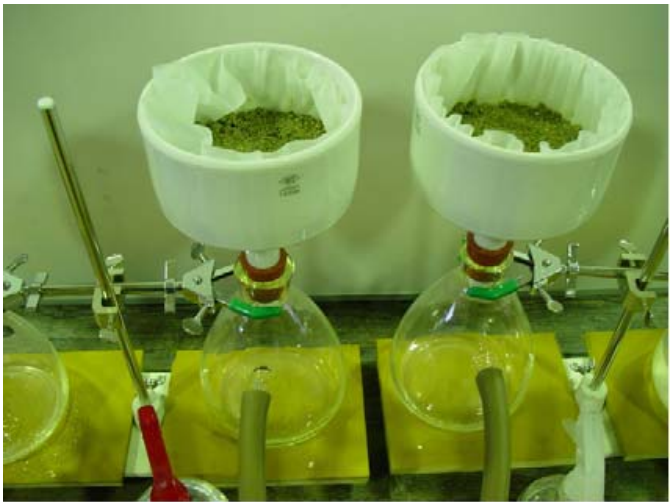
写真 1 通水試験の状態
