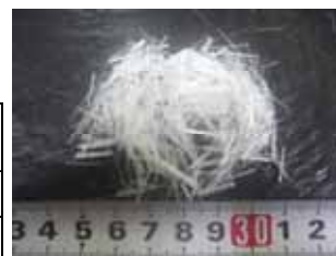
写真-1 短繊維引張補強材
