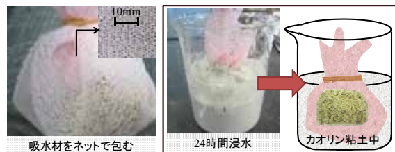
写真-1 土中内の吸水比試験方法
