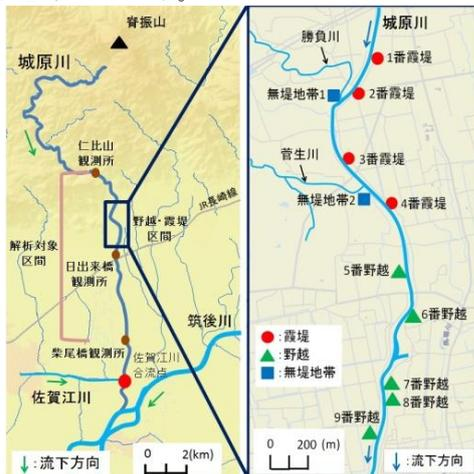
図-1 城原川平面図および野越・霞堤区間拡大
