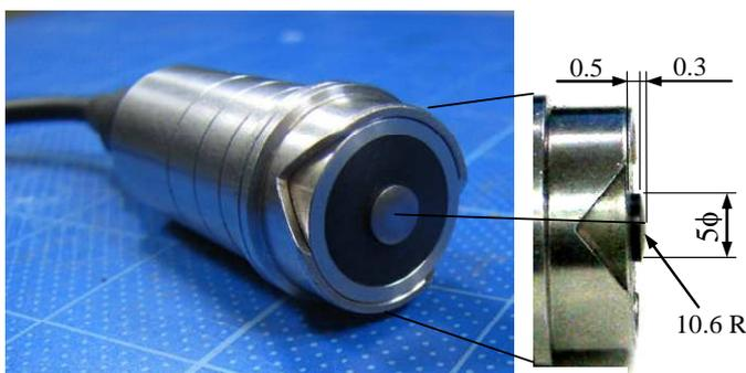
図-1 電磁膜厚計のプロープ
