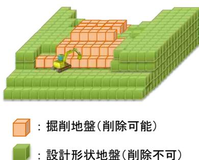
図-3 設計形状による掘削規制概念図
