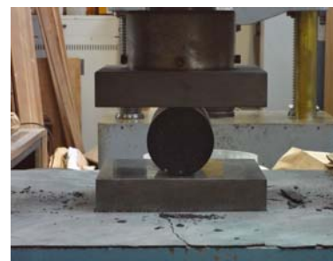
写真 1 割裂引張強度試験
