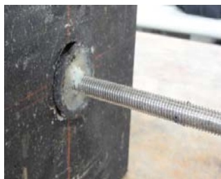
写真2 アンカー引抜き試験供試体
