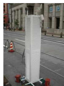
写真-1 百葉箱型温度観測装置
