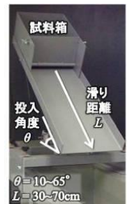
写真-2 投入装置
