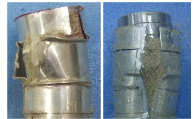
写真-1 実験後の PO 型模型(左), PL 型模型(右)
