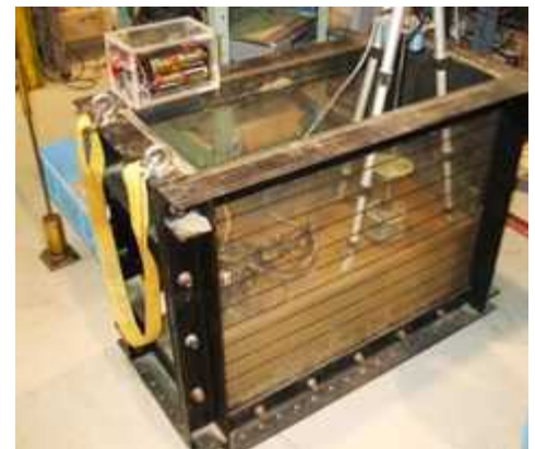
写真-1 小型土槽
