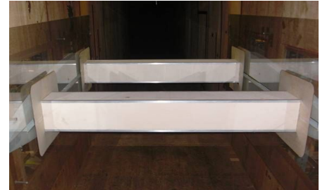
図1 模型設置状況(タンデム角柱)
