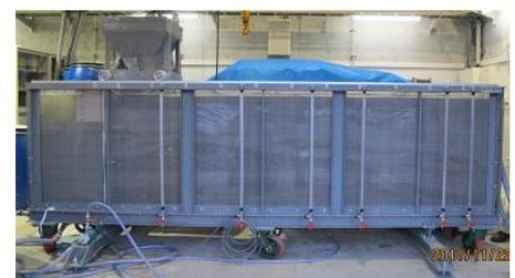
図-2 海面埋立地を再現した二次元土槽
