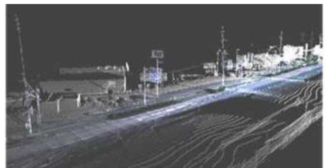
図-1 道路空間の点群データ
