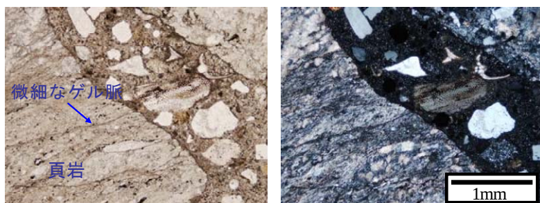
写真-3 コア B 粗骨材-モルタル界面の偏光顕微鏡写真 (左：下方ポーラーのみ 右：直交ポーラー)
