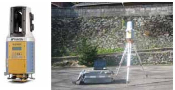
図 3 TOPCON・GLS-1500 と測量状況
